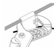
Montagem do conector na rede elétrica usando o alicate bomba d'água.
